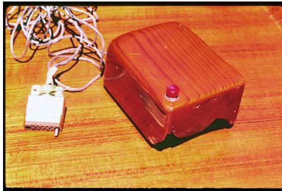
Figure 1 - La souris inventée par Douglas Engelbart (1963)
